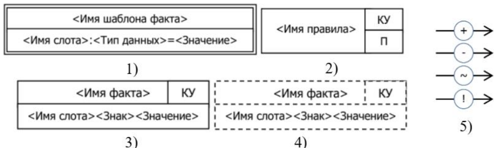
Рисунок 1 – Основные элементы RVML: 1) шаблон факта; 2) узловой элемент правила; 3) факт; 4) условие; 5) связи элементов с указанием действий
